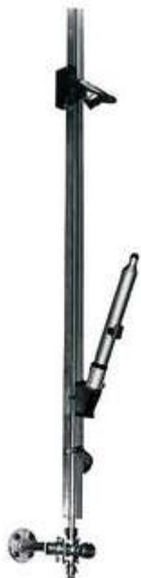
Модель Seetol разработана с целью усовершенствования и упрощения считывания показаний с высоких уровнемеров с нулевой отметки, используя перископ. Такой способ исключает погрешность от параллакса, которая существует с традиционными уровнемерами и, следовательно, обеспечивает надежность считывания с точностью до 1 мм по максимальной длине шкалы в 20 метров.
